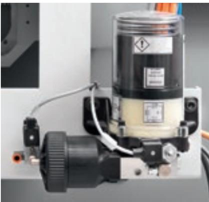
Lubrification automatique tête de perçage BHZ 29 2L.
