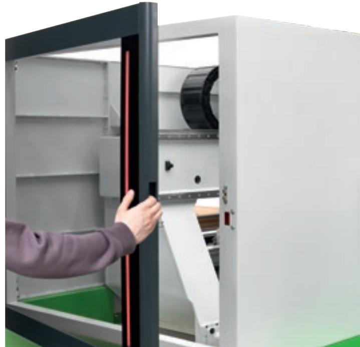
Protection intégrale du groupe opérateur. La large porte ouvrante garanti une visibilité maximale de travail et permet d'accéder aisément aux groupes opérateurs.
