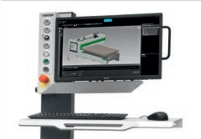
PC avec système d'exploitation Windows en temps réel et interface logiciel B\_SOLID incluant un système anticollision.
