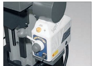
Code 40026 Power: Avance automatique longitudinale mécanique de la table
