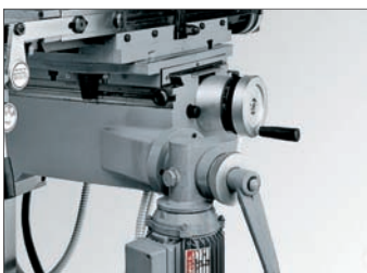
Code 40006: Avance rapide verticale de la table
