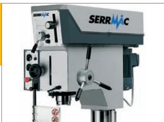
Code 40083: Descente automatique avec embrayage électromagnétique 24V
