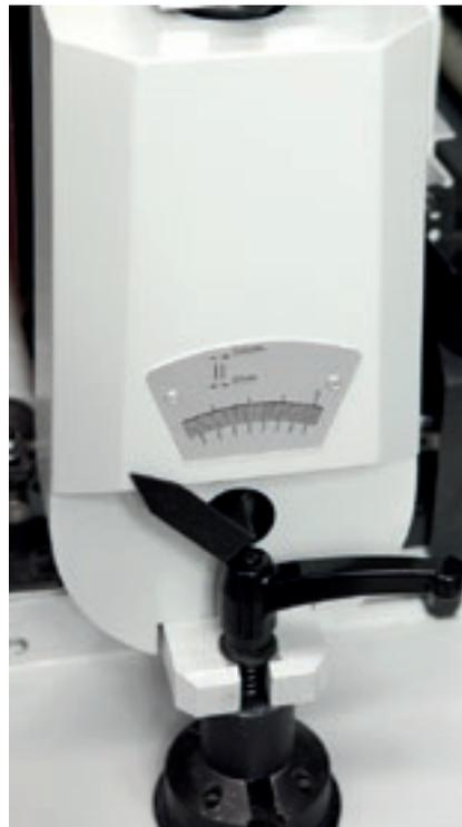
Le **groupe Rouleau** est extrêmement précis et efficace. Suivant la dureté du caoutchouc employé et le diamètre du rouleau, le groupe peut être utilisé pour calibrer, poncer ou satiner.
