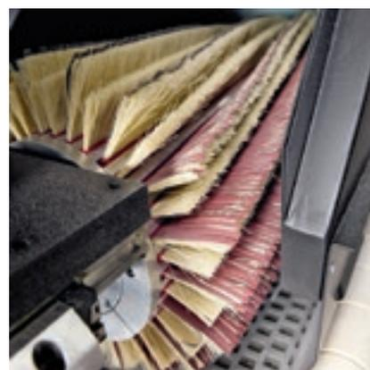
Robuste et fiable, la **brosse longitudinale** est munie du système d'oscillation transversale pour uniformiser la qualité de finition sur l'objet et de réglage d'interférence électronique actionnable depuis le tableau de commande. Les poils abrasifs peuvent être rapidement remplacés sans devoir extraire le groupe de la machine. Brosse à inserts abrasifs de 300 ou 400 mm de diamètre.
