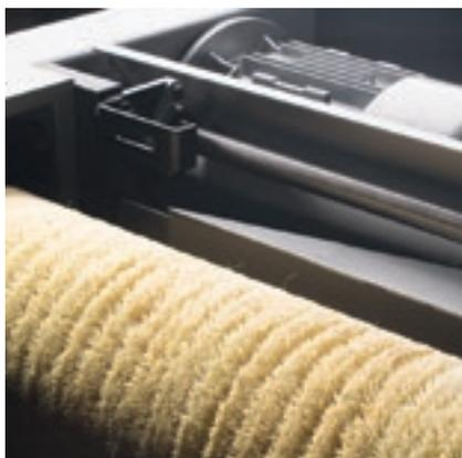
La **brosse de nettoyage du panneau** peut être munie de poils de différents matériaux pour satisfaire les exigences les plus élevées de nettoyage des panneaux façonnés.
