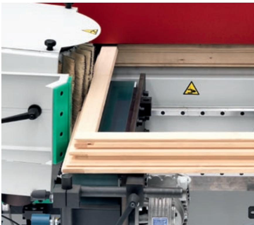
Le **Groupe à brosses verticales win** est un système de ponçage à brosses verticales rotatives. L'unité permet de poncer, en brossant, les profils et les surfaces latérales de l'objet afin de garantir finition et homogénéité. Chaque groupe,
