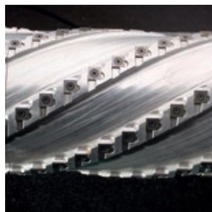
Le **groupe HPG** est conseillé pour le calibrage de panneaux lamellés car il permet d'éliminer plusieurs millimètres en un seul passage.
